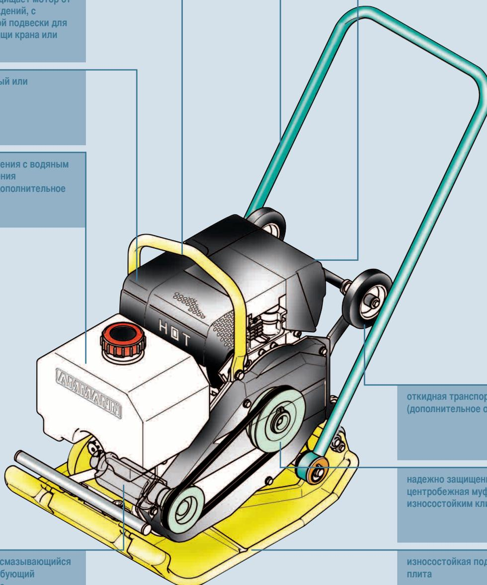
откидная транспортная тележка (дополнительное оборудование)
